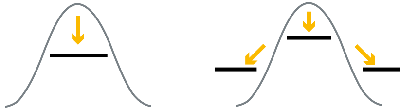
Abbildung 15/aF: Funktionsprinzip der Lastabschaltung (links) und Lastverlagerung (rechts)
