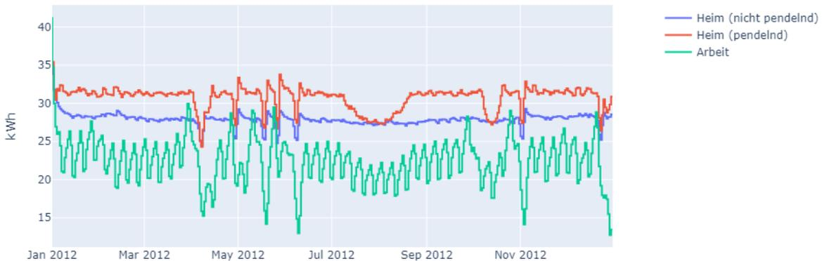
Abbildung 38: Tagesmittelwerte des SOC über den Jahresverlauf für alle Raumtypen unterschieden zwischen Fahrzeugen, die zuhause bzw. Beim Arbeitgeber laden.
