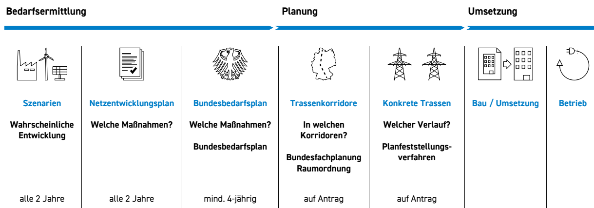
Abbildung 2: Gesamtablauf zur Umsetzung von Leitungsvorhaben
