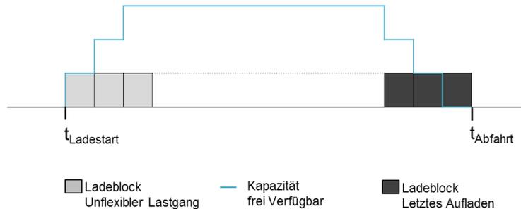
Abbildung 3-10: Schematische Darstellung des Ladelastgangs, Bedarfsgangs und des Kapazitätsgangs für ein Elektrofahrzeug
