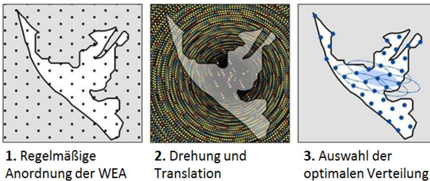
Abbildung 3-12: Ermittlung der besten Windparkkonfiguration
